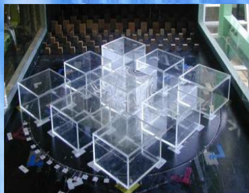
建物内の通風換気実験
